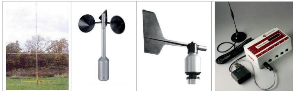
Nous utilisons un anémomètre à coupelles « first class » adapté aux mesures de vents horizontaux. Nos anémomètres optico-électroniques sont accompagnés d'un certificat de calibration, correspondant aux standards internationaux (Certifié selon IEC 61400-12-1 / MEASNET).
