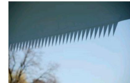
Photographies d'une pale dotée d'un système TES (peigne / dentelure)
